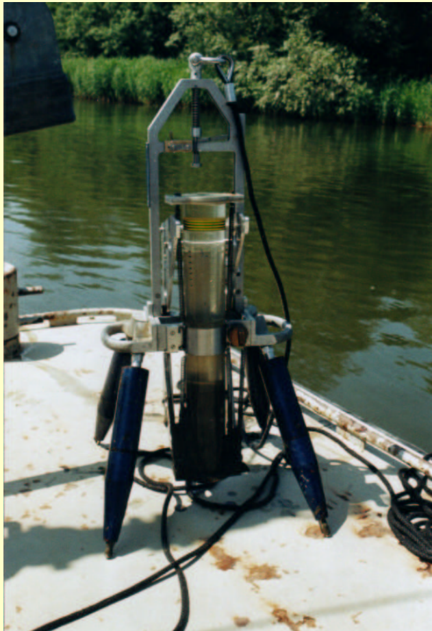
Bemonstering van de waterbodem met behulp van een Jenkin surface mud sampler ten behoeve van een studie naar het gedrag van zware metalen in de toplaag. [foto: Gerard van den Berg, RIZA]
